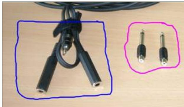
Die Normadapter: Die Cinch-Kabel vom Player (CD, Kassette) werden mit den Adaptern verbunden, die Klinken ins Mischpult eingesteckt.
