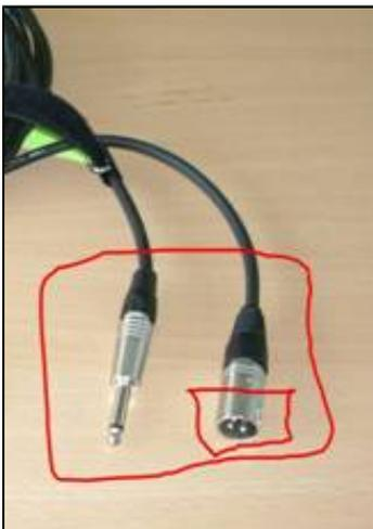
Die Kabel für den Anschluss von Instrumenten finden sich ebenfalls mit Metallkoffer. Sie werden benötigt, um die Instrumente (Klinkenanschluss) mit der Box (Klinkenstecker) zu verbinden. Das Instrument kann dann vom hinteren Bühnenraum gesteuert werden.
